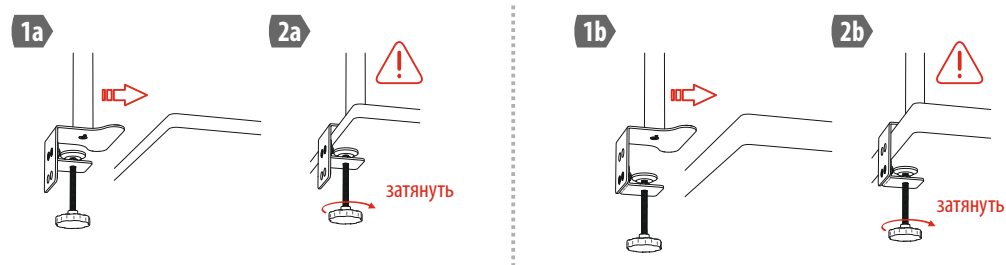
Рисунок 3. Установка кронштейна. Вариант «а» для столешниц до 25 мм, вариант «б» для столешниц до 50мм
