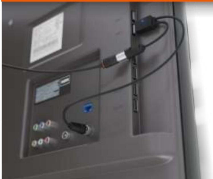
Инжектор BAS-8001 предназначен для питания активных КОМНАТНЫХ ТВ антенн, не имеющих собственного источника блока питания\*.
