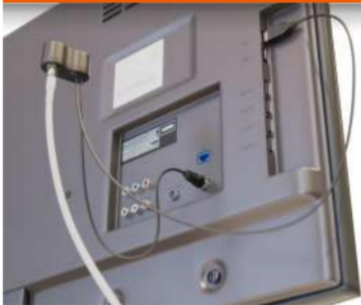
Инжектор BAS-8002 предназначен для питания активных НАРУЖНЫХ ТВ антенн, не имеющих собственного источника питания (например, сетевого адаптера).\*
