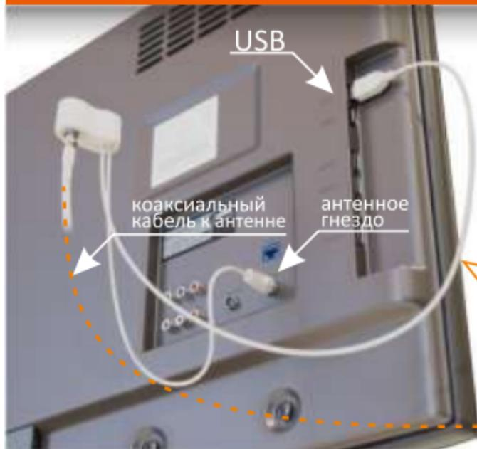
USB инжектор это устройство для питания ТВ антенн с усилителем. Позволяет без дополнительных проводов подать питание на антенный усилитель (обычно встроенный в антенну) по коаксиальному кабелю. Подключается между антенной и телевизором (ТВ приставкой).
