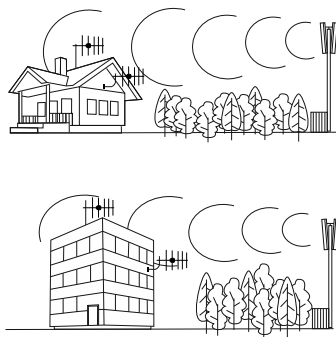
Рис.4 Варианты установки приемо-передающей антенны.
