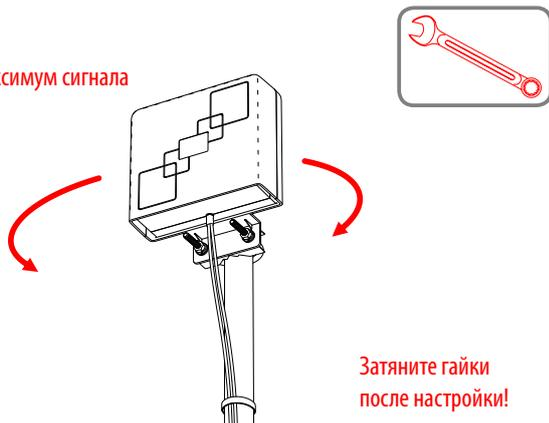
Затяните гайки после настройки!
