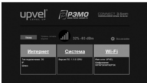
Рис.5. Уровень сигнала до настройки направления в окне краткой информации
